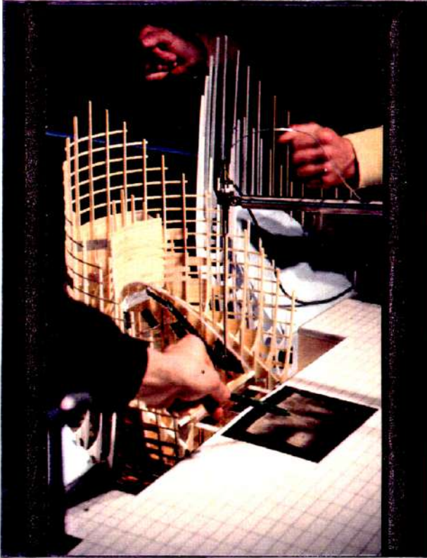
ESSAIS REALISES EN SOUFFLERIE AU C.S.T.B.
